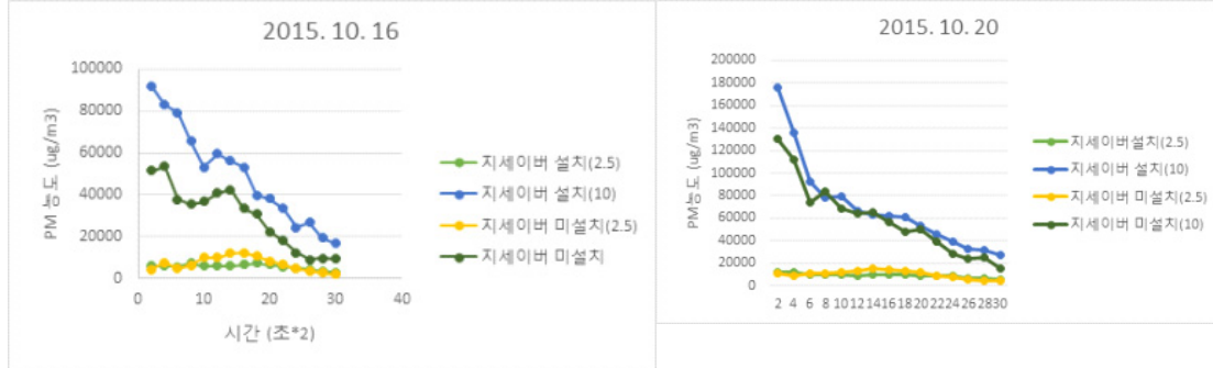
[그림 20] G-saver 설치 유무에 따른 PM2.5, PM10의 농도 변화
