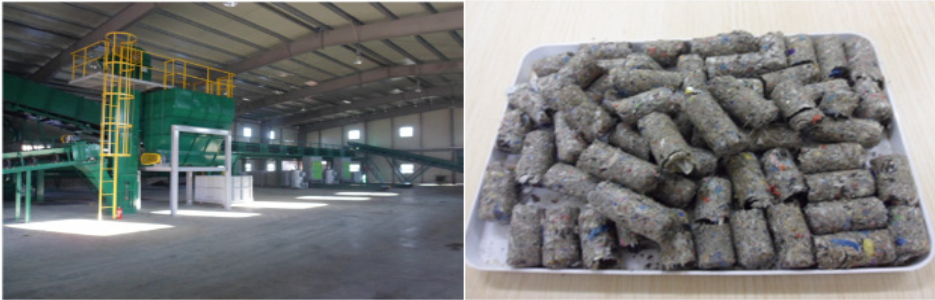
<사진 4-7. RDF 설비 및 생산된 RDF>
